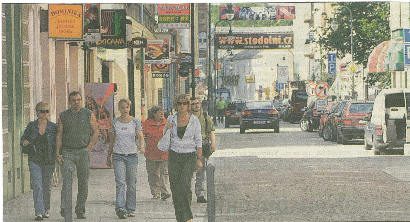
STODOLNÍ ULICI OPRAVILI. Nejznámější ostravské centrum zábavy plné barů a hudebních klubů se dočkalo nového povrchu. Vozovka je ze žulové kostky, chodníky z pásových žulových desek. Více místa je nyní pro předzahrádky jednotlivých restaurací. Přibýly také další sloupky veřejného osvětlení, ale i stromy a plakátové sloupky. Rekonstrukce stála 18,2 miliónu korun. Slavnostní symbolické otevření ulice je připraveno na pátek 18. srpna v 17 hodin. (kab)
